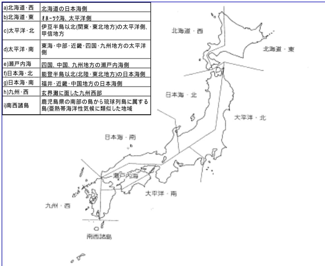
図 11 金属材料の腐食性に注目した気候区分
