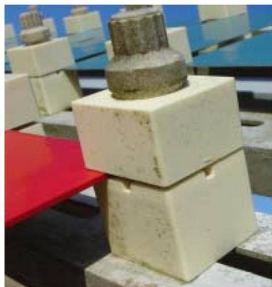
写真2 試料保持具(左：磁器製、右：プラスチック製)
