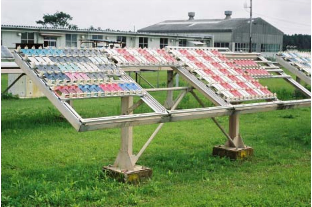
写真 1 直接暴露試験装置に試料を取り付けた暴露試験状況例
