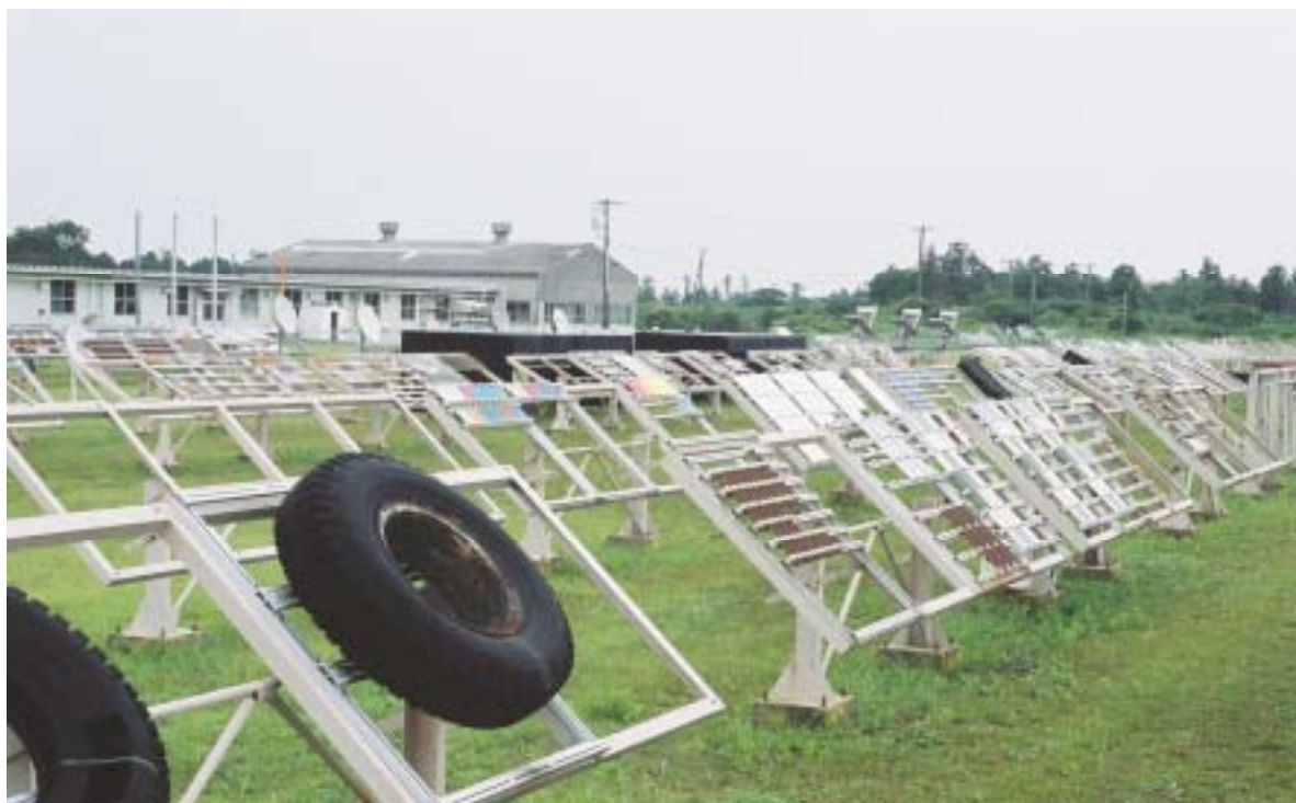
写真 6 暴露試験場の一例
