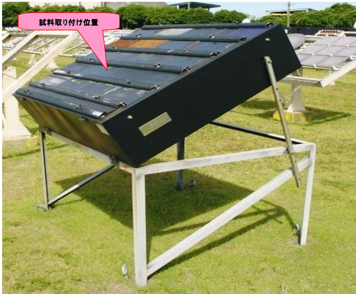
写真4 ブラックボックス暴露試験装置例（上面開口型）
