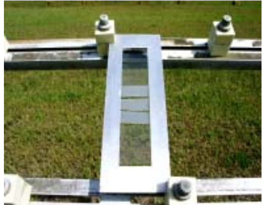
写真3 ポリエチレンリファレンス試験片の暴露試験している状況
