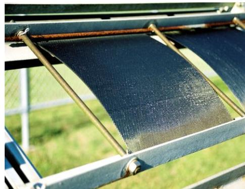
↑ 曲げ変形負荷による暴露試験
