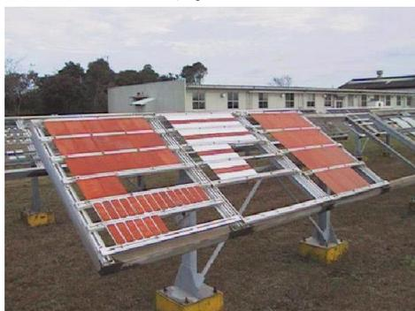
写真4 屋外暴露試験の状況(銚子)
